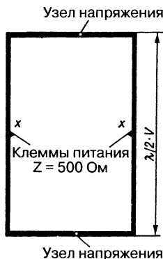
Рис. 26.22. Контурно-щелевая антенна
