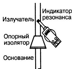
Рис. 31.38. Применение индикатора резонанса с вертикальной антенной
