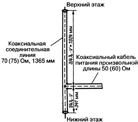
Рис. 25.29. Возбуждение двухэтажной антенны Big Wheel (размеры для резонансной частоты 145 МГц)
