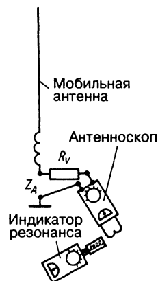
Рис. 31.44. Схема измерений предельно низких входных сопротивлений
