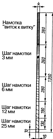
Рис. 28.9. Вертикальная мобильная антенна-катушка для диапазона 15 м
