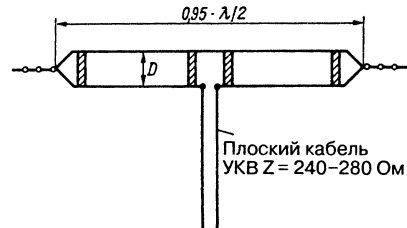
Рис. 10.4. Петлевой вибратор в качестве КВ антенны
