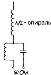
Рис. 19.85. Принципиальная схема согласования КВ спиральной антенны
