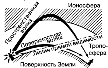
Рис. 2.3. Пути распространения поверхностной и пространственной электромагнитных волн
