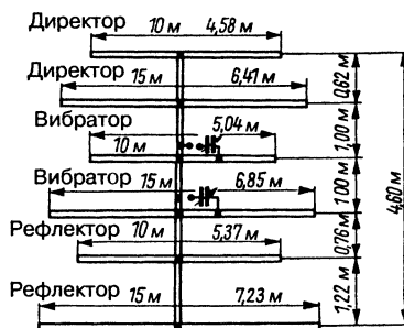
Рис. 18.39. Двухдиапазонная остронаправленная антенна с вложенными элементами на 10 и 15 м
