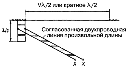
Рис. 10.8. Излучатель с концевым питанием через ненастроенный фидер
