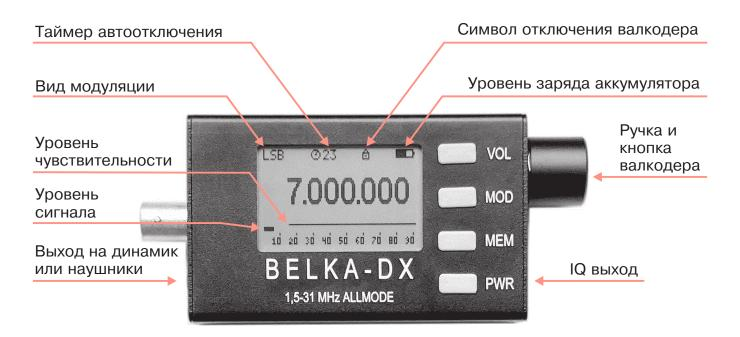
Диапазон рабочих частот радиоприёмника 1,5 - 31 МГц. Входные цепи приёмника оптимизированы для работы с телескопической антенной длинной около 80 см. Для получения высокой чувствительности с телескопической антенной, к приёмнику должен быть подключен "противовес" в виде провода наушников или колонки длиной около метра.
